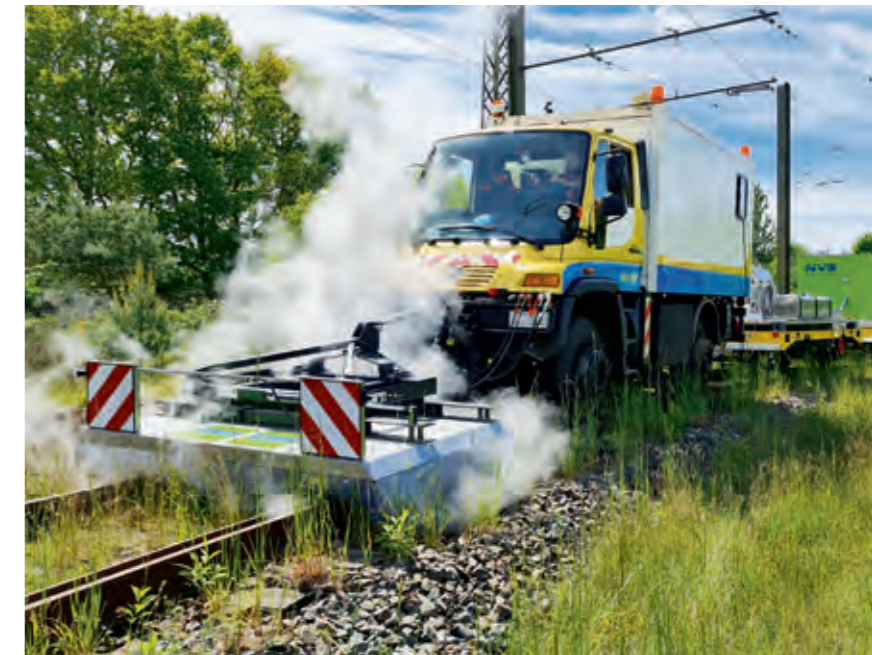
Die thermische Unkrautbekämpfung basiert auf dem einfachen Prinzip, dass weiches pflanzliches Gewebe abstirbt, sobald es Temperaturen deutlich über 42 °C erreicht
